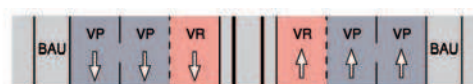
Profil type 2 x 2 voies + VR à droite + BAU ou Profil type 2 x 2 voies + VR à gauche + BAU
